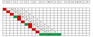
**Gambar 4.** Visualisasi Pencocokan *String* dengan Algoritma *Brute Force*Sumber:
