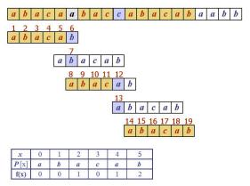
**Gambar 5.** Visualisasi Pencocokan String dengan Algoritma KMP Sumber:
